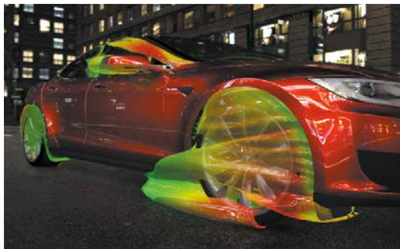
PowerVIZを使用してPowerFLOWシミュレーションの可視化を行い、RTTのDeltaGenを使用してレンダリングをした画像 (画像提供：Tesla Motors)
